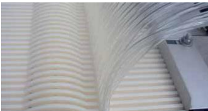
Figura 9.5. Particolare di membrana piana
