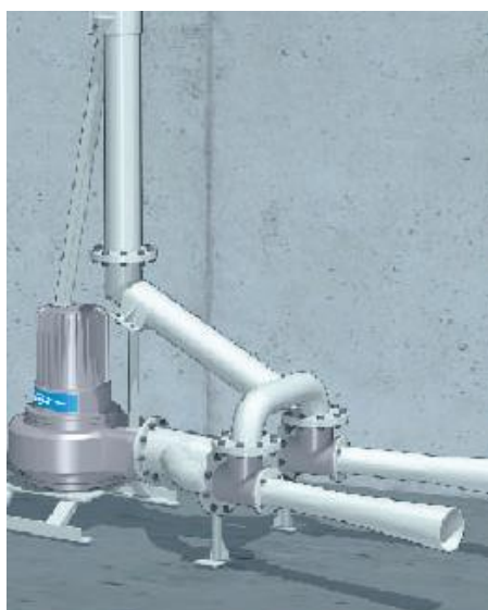
Figura 11.1. Schematizzazione del sistema flow-get (Flygt)
