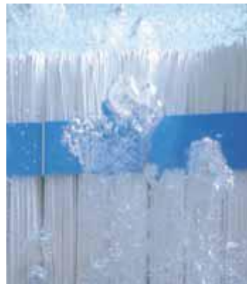
Figura 9.6. Particolare di membrana a fibra cava
